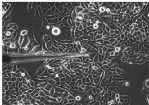
細胞に触れているマイクロセンサーの先端
